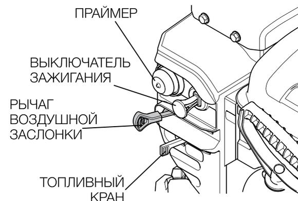
**Выключатель зажигания** расположен на корпусе двигателя и управляет подачей напряжения на свечу зажигания. Рабочее положение – «ON» (ВКЛ), чтобы заглушить мотор двигателя необходимо перевести выключатель в положение «OFF» (ВЫКЛ).
